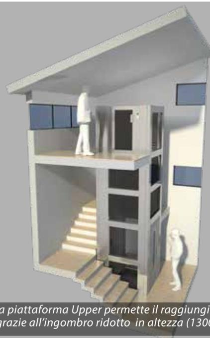
L'utilizzo della piattaforma Upper permette il raggiungimento di piani "sottotetto", grazie all'ingombro ridotto in altezza (1300 mm).
