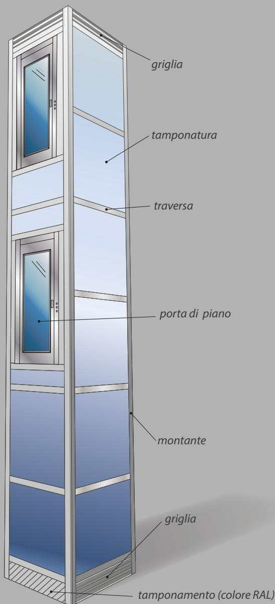
La struttura metallica EP standard prevede un tamponamento a filo interno (VFI) ma, a richiesta, si può avere la soluzione con tamponamento a filo esterno (VEX)\*. La soluzione VFI ha il tamponamento che si monta dall'interno, mentre la VEX si tampona dall'esterno.
