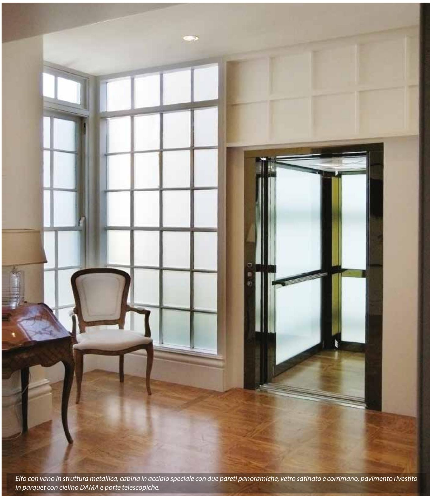
*Elfo con vano in struttura metallica, cabina in acciaio speciale con due pareti panoramiche, vetro satinato e corrimano, pavimento rivestito in parquet con cielino DAMA e porte telescopiche.*
